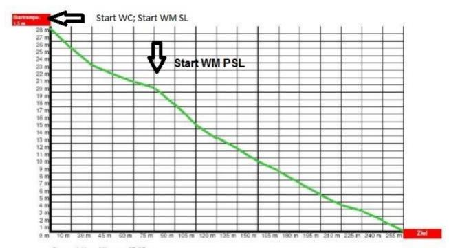
Gesamthöhendifferenz: 27,25 m Durchschnittsgefälle: 10,9 % Steilster Streckenabschnitt: 17 %
